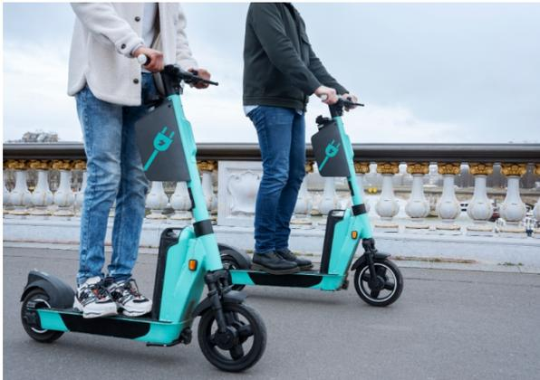
根据规范手册的定义, PLEV或电动滑板车是一种具有一个或多个车轮, 仅由电动机驱动的单座车辆。设计最高速度为6-25公里/小时 (4-16英里/小时)。如果车辆配有自平衡控制系统, 则只能配备一个座椅或鞍座。另外, 手册中还详细列出了此类车辆的各种特性, 如关于制动系统、结构的整体稳固性和动态特性等。
