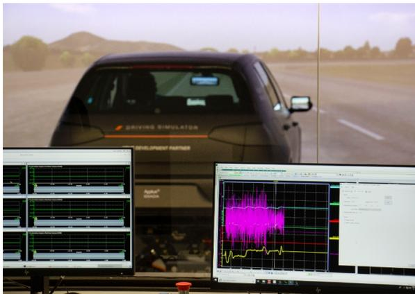
**乘适性开发**仍是一项巨大的挑战，特别是在**仿真**方面，不仅需要复杂的车辆建模，还要在各项互相冲突的要求之中，寻求精妙的平衡。测试结束后，还需要有经验的驾驶员实际感受车辆，并验证结果。通常，该步骤必须要有**原型实车**的介入。
