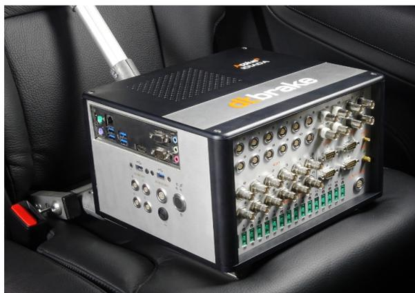
**dbBrake:** 用于制动测试（制动性能及耐久）的数据采集系统
